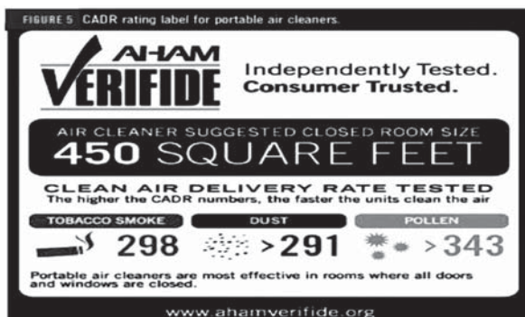
Εικόνα 27 Ετικέτα απόδοσης μηχανήματος καθαρισμού αέρα.
